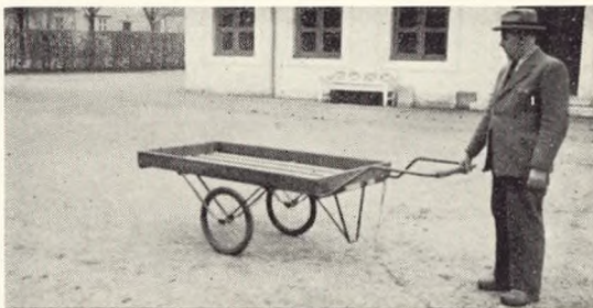
Fig. 13. Vogn til lette transporter. Kan spændes efter en cykle.
