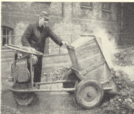
Fig. 28. A/S Lars Arnbak & Co. Vogn med motor og forhjul, fuldt drejeligt; vognkasse til at vippe.
