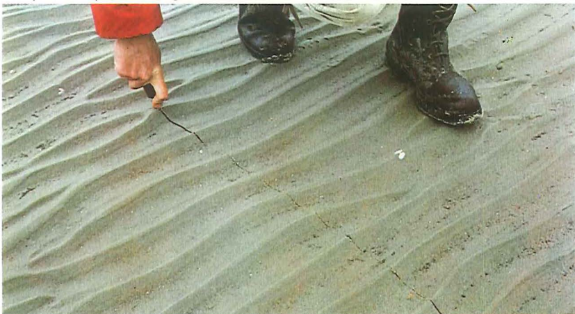
Figur 11 A. Viser første stadium i opmåling af ribber (her bølgeribber) med karton og sprayfarve. Der "skæres for" med kniven, for at kartonen lettere kan sættes ned i sandet. Derefter fortsættes der som vist i Varv nr 3, figur 11 B - E.
