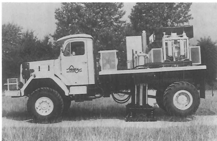
Figur 10. Med en passende stor energi kan en vibrator monteret på en lastbil frembringe en kontinuert serie chokbølger til seismiske undersøgelser af den højere liggende undergrund (Firmaet Prakla, Vesttyskland).
