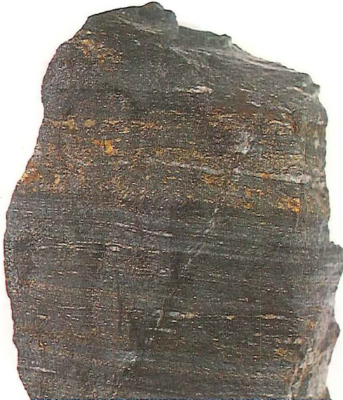
Figur 4. Malprøve fra Outokumpu. De gule striber er lag med sulfidminerale kobberkis og svovlkis.
