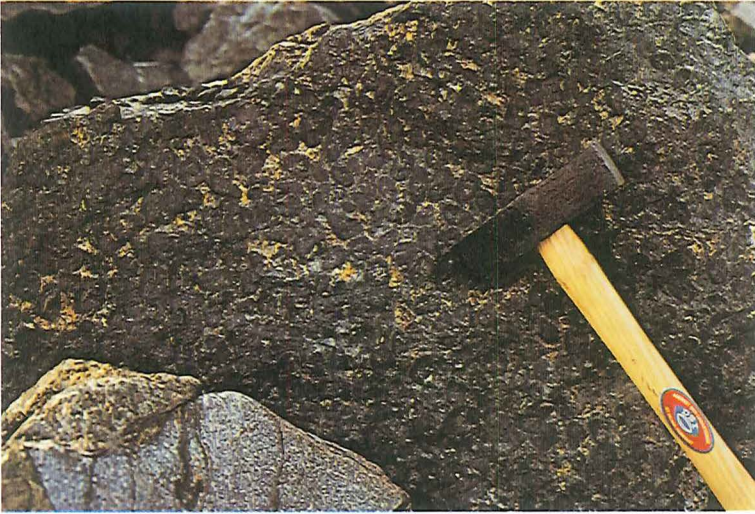
Figur 3. Nikkelmalm fra Kylmäkoski. Man ser, at sulfiderne (kobberkis, nikkelholdig magnetkis og svovlkis) er grundmassen, hvori er indlejret pyroxen- og serpentiniserede olivinminerale, der er hovedbestanddelene i denne feldspatfrie, ultrabasiske bjergart (peridotit), som altså har et relativt lavt indhold af kiseltsyre ( \text{SiO}_2 ).
