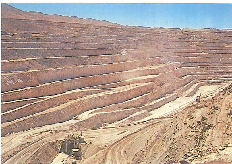
Udsnit af dagbruddet i Chuquicamata kobberminen. Hver bæk er cirka 18 meter høj. Fotos Vagn Jensen.
