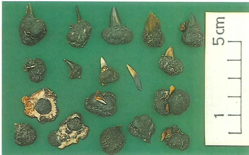
Figur 4. Mangán-jern materiale afsat på hajtænder.
