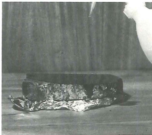
Figur 1. Den udsavede, tilslebne og ætsede prøve anbringes i aluminiumsfolie og overhældes med acetone.
