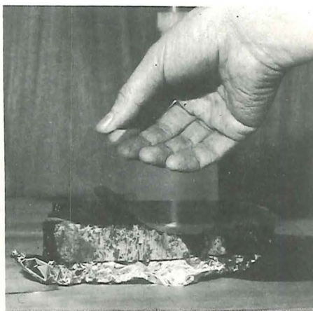
Figur 2. Acetatfilmen rulles forsigtigt ned på overfladen, skubbende en vold af acetone foran sig.
