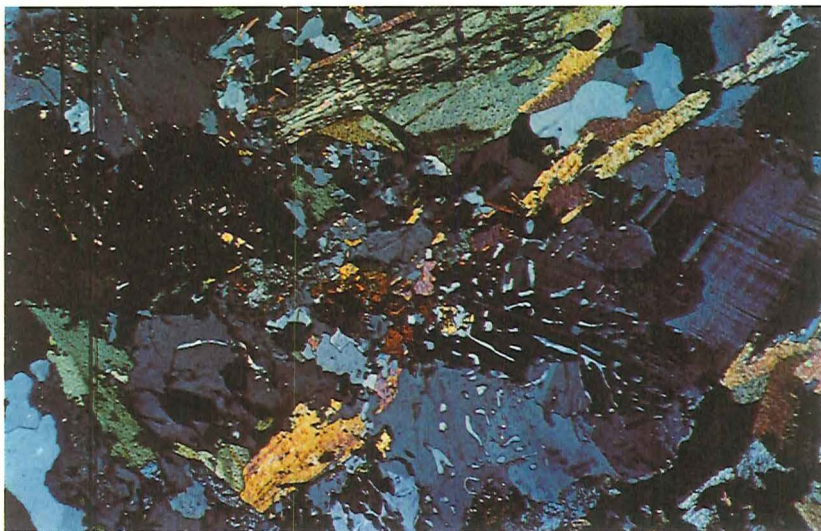
Fig. 4. Tyndslib af Rønne granit, krydsede polarisatorer. Stærkt farvet mineraler er henholdsvis hornblende og biotit, mørkegrå og lysegrå mineraler er feldspat og kvarts. Bemærk den "orm-agtige" myrmekit tekstur, der skyldes sammenvoksningen mellem kvarts og mikroklin.
