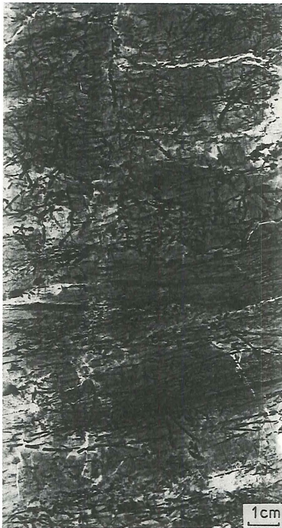
Figur 3. Røntgenop- tagelse af Hodde Ler. Der ses mange svovl- kis-udfyldte (mørke) gravegange, både af den fine trådede og af den tykkere stæng- lede type. Lagdeling- en (næsten vandret) kan også skelnes.
