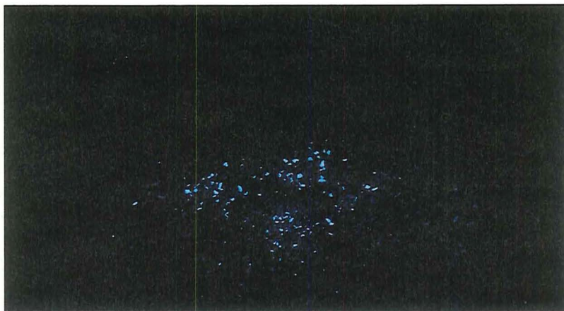
Figur 5. Samme prøve som i fig. 4, men her fotograferet i ultraviolet lys. Man ser tydeligt de talrige scheelit-korn.
