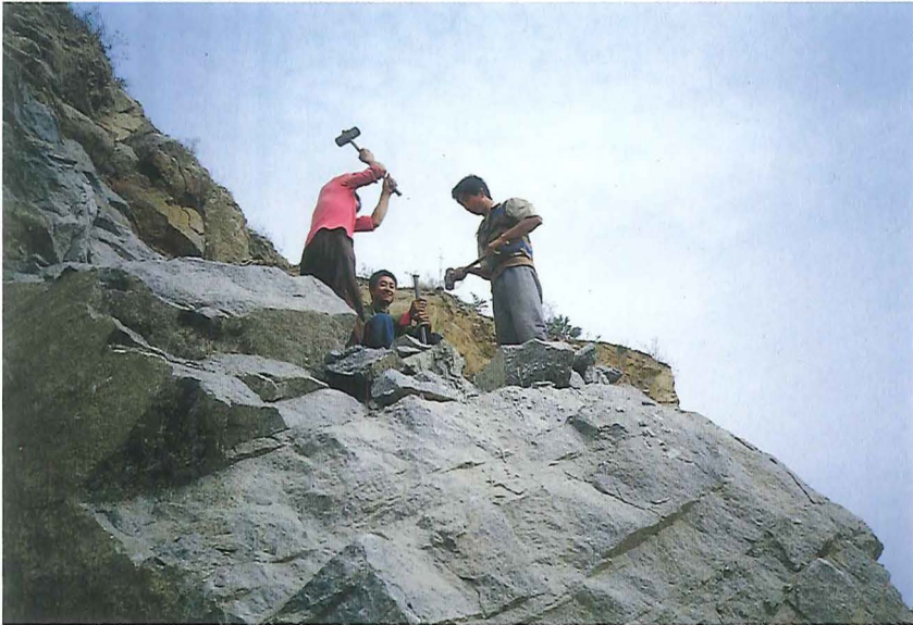
Figur 10. Meget af Kinas geologiske industri er helt på højde med den, vi kender fra vesten. Store maskiner flytter de brudte bjergarter, kilometerlange transportbånd og moderne oparbejdningsanlæg. I den situation forekommer det lidt mærkeligt at se, at hullerne til sprængladninger, der senere skal flytte tonsvis af sten, hamres ud ved håndkraft i stedet for at anvende boreudstyr. Hvor et trykluftbor kunne lave huller i løbet af en times tid, anvender flittige kinesere mange timer med mejsel og hamre.
