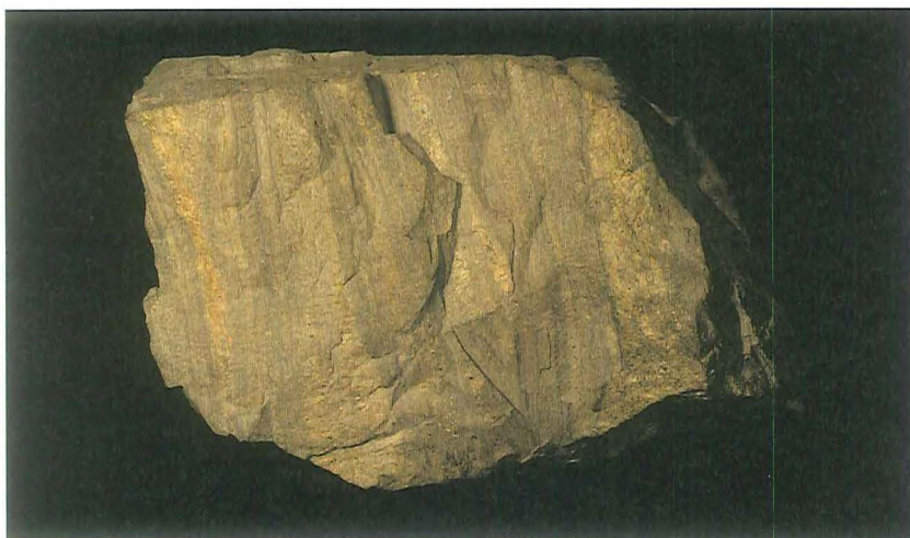
Figur 2. Ca. 10 cm bredt håndstykke af massiv båndet kompleks malm. De gule bånd er pyrit, brunlige farver er zinkblende og blågråt skær er blyglans.
