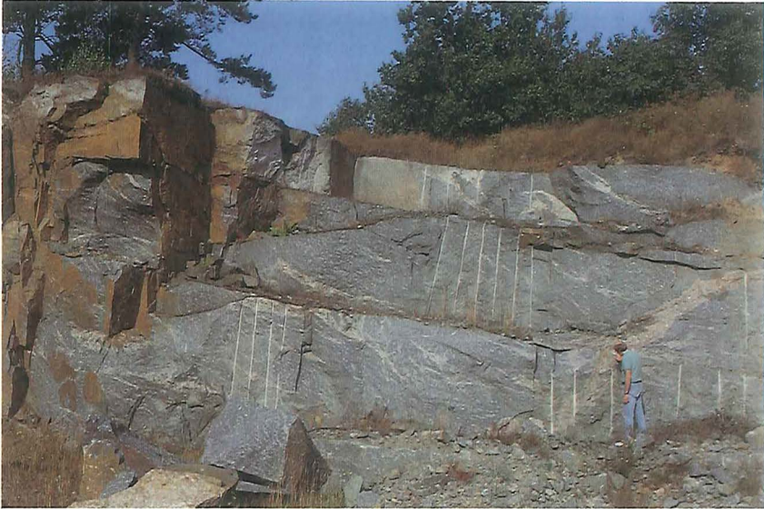
Figur 10. Paradisbakke migmatit med gennemskærende pegmatitgang. De lyse lodrette 'striber' er spor efter borer til sprængninger. Bertelegård Stenbrud.
