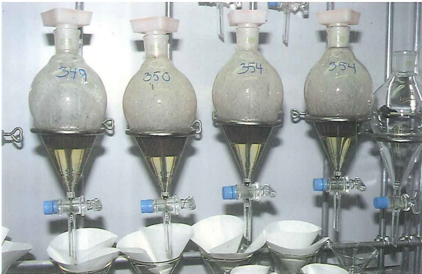
Figur 10. Tungvæskeseperation i DGU's sedimentlaboratorium. Separationen foregår i 500 ml skilletrugte. Tungvæsken er bromoform, der foruden at være tung er temmelig giftig, så der arbejdes i stinkskab.
