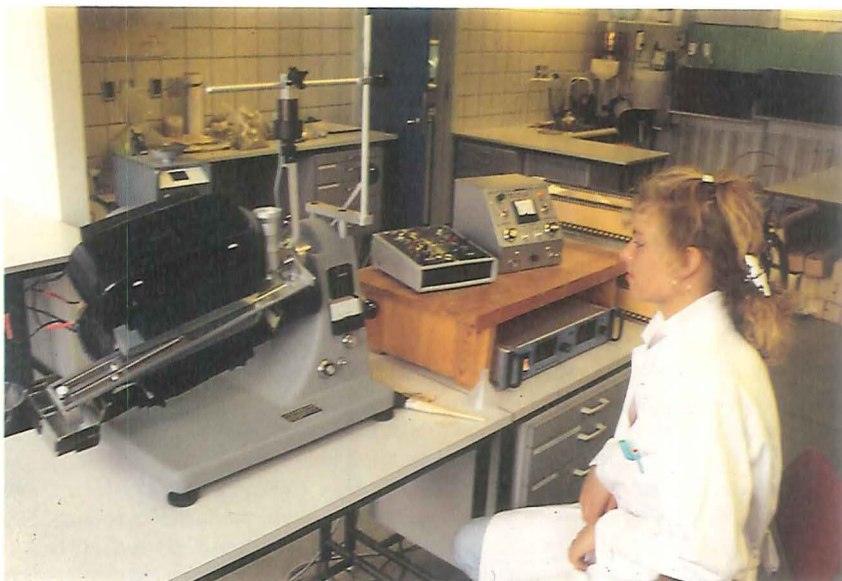
Figur 11. Magnetseparation i laboratoriet. Mineralerne deles efter deres magnetiske egenskaber på skinnen, der ligger i et meget kraftigt magnetfelt. Det sorte bånd er hovedsageligt ilmenit, og det røde bånd er overvejende granat.
