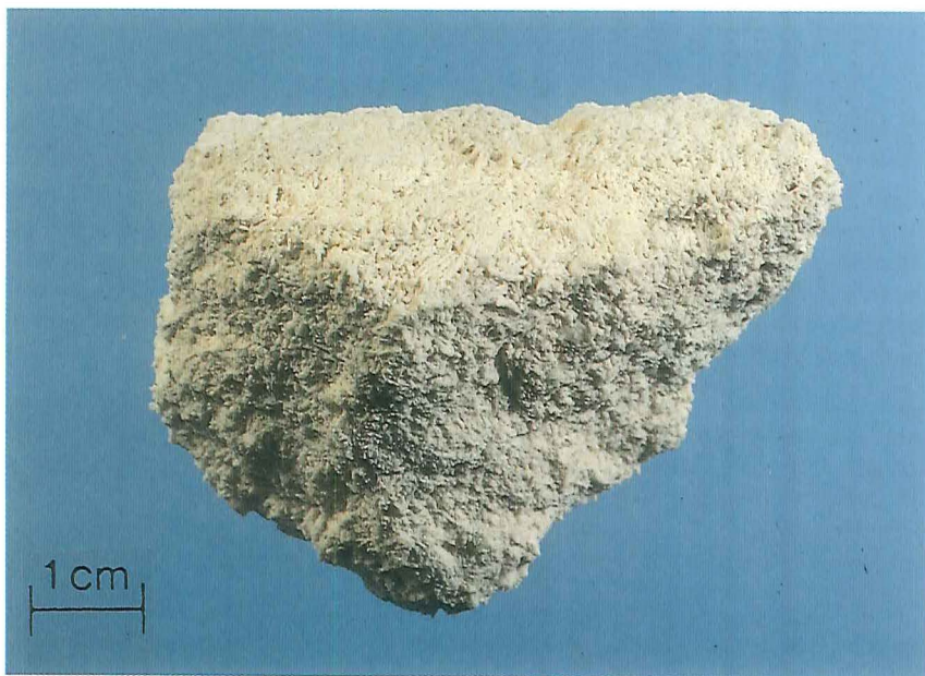
Figur 2. Bryozokalk fra Faxø Kalkbrud. Bryozokalken er opbygget af talrige små grene på under 1 mm i diameter. Bryozoerne er omgivet af finkornet kalkmudder.
