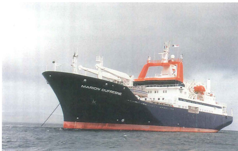
Figur 1: Det franske boreskib 'Marion Dufresne II' under det første IMAGE togt i GIN-havet i sommeren 1995. Skibet er udstyret med en moderne 'Piston'-prøvetager, der gør det muligt at tage uforstyrrede sedimentkerner af op til 50-60 meters længde.
