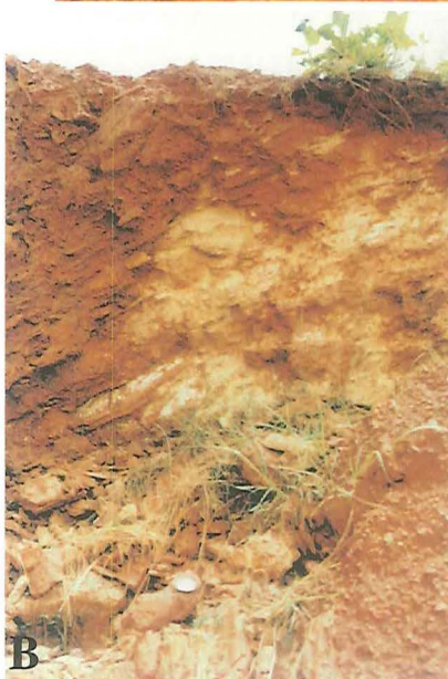
Figur 3. A) Nærbillede af bauxiten. B) Flammet bauxit. De røde og gule farver bruges som lødighedsindikatorer. Gule farver indicerer lidt jern og dermed meget aluminium. C) Nærbillede af overgangen mellem det phyllitiske udgangsmateriale og bauxiten.
