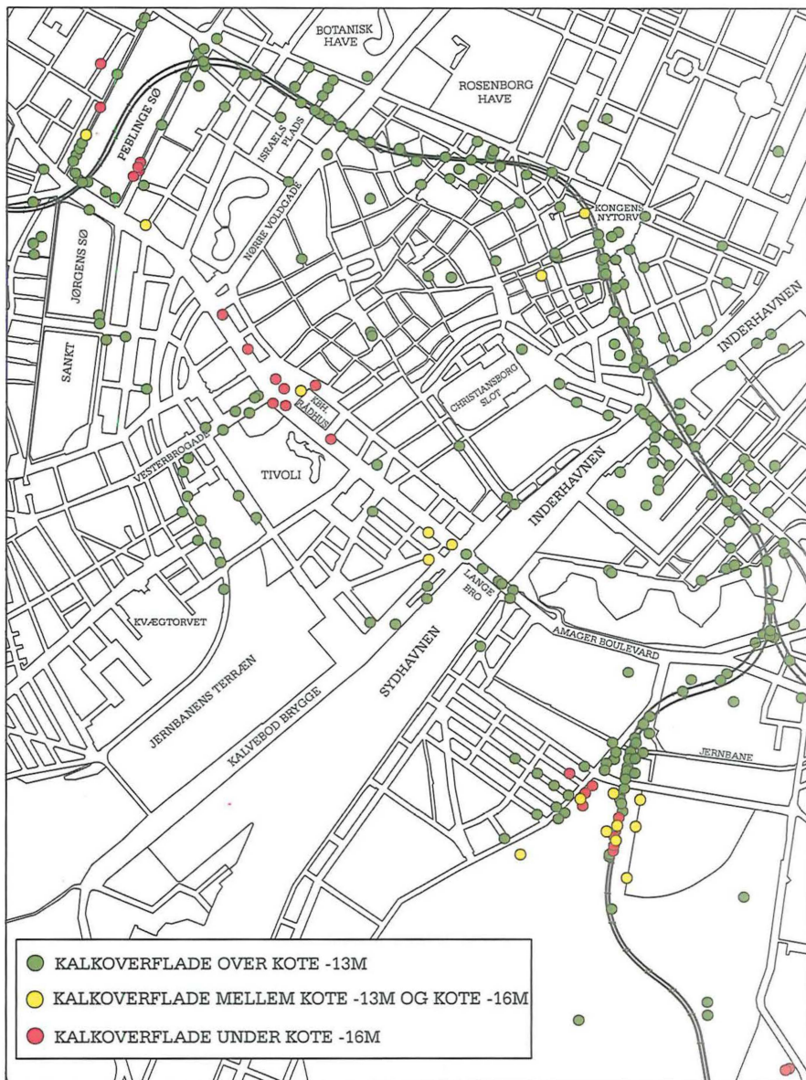
Figur 3. Forløbet af Københavns Metro og et udsnit af den store mængde borer, der er udført i København.
