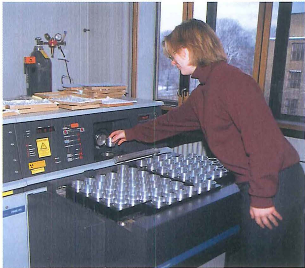
Figur 4. Røntgenfluorencensspektrometret på Geologisk Institut. Prøven i det lille aluminiumsbæger anbringes manuelt i spektrometret, men en prøveskifter til automatisk analyse af op til 72 prøver findes også i laboratoriet. Foto: Christoffer Due-Boje..
