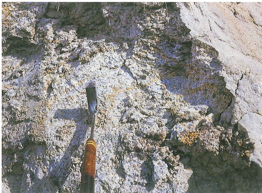
Kaoliniseret grundfjeldsgnejs. Denne har stadig bevaret sin oprindelige foliationsstruktur på trods af, at den helt har mistet sin oprindelige hårdhed.
