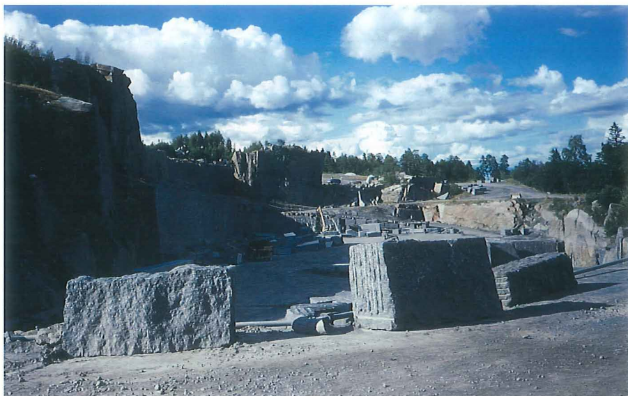
Larvikitbruddet ved Tjølling i Sydnorge. Larvikit sprænges ud i store massive blokke uden sprækker og skæres op i tynde plader, der poleres og anvendes som facadesten.
