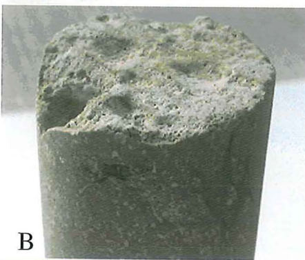
Figur 11. (a) En cylindrisk prøve af Midale Marly dolomit som den ser ud før et eksperiment. (b) Efter en måneds \text{CO}_2 -injektion ses der især i indløbsenden af prøven tydelig opløsning af bjergarten. Bemærk de små huller fra opløste mineraler. Der observeres også en stigning i prøvens porøsitet og permeabilitet under strømningseksperimentet. Prøvens diameter er 2,5 centimeter. (c) Scanning elektron mikroskop billedet viser en typisk Marly dolomit med veludviklede dolomitkrystaller (do) samt lidt accessorisk alkalifeldspat (af) og pyrit. (d) Efter \text{CO}_2 -injektion er dolomit-krystallerne markant ætsede i indløbsenden, med en karakteristisk udvikling af udhulede krystaller. (c) og (d) er i samme skala (GEUS Kerne Laboratorium, 2003).
