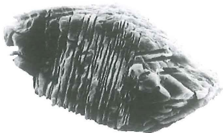
Figur. 5: Chok-kvarts. Sådanne korn har været udsat for meget høje og pludselige tryk. Kvartskornene er gennemsat af tynde, svage zoner, som ved ætsning med syre ses som revner. Chok-kvarts dannes især ved nedslag af større meteoritter. Kvartskornene ved K/P grænsen er typisk omkring 0,1 millimeter store.
