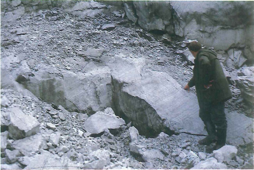
Figur 9. Gips og anhydrit i bruddet ved Römerstein. De friske brudflader består mest af anhydrit, der ved påvirkning af luftens fugt omdannes til gips.
