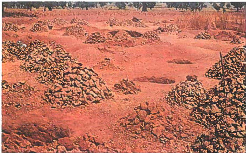
Skakter der fører ned til det niveau i den delvis forvitrede undergrund, hvor leret har den rette sammensætning. Nord-Ghana.
