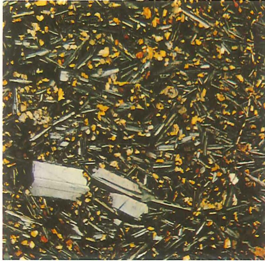
Figur 2a. Basalt fra Hawaii. De lysegrå, listeformede korn er plagioklas, de farvede små korn er pyroxen. Bemærk at plagioklaskornene både forekommer som små "lister" og store korn.
