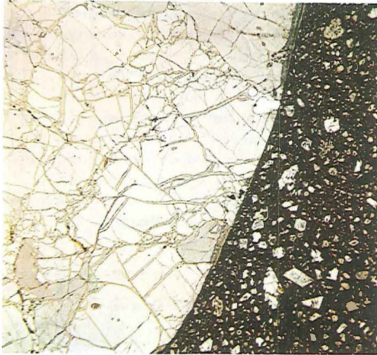
Figur 8. Peridotitinklusion i basalt. Basalten er porfyrisk med strøfkorn af olivin og pyroxen. I grundmassen ses feldspatletter, sort malm, pyroxen og brun glas. Inklusionen indeholder olivin (farveløs), pyroxen (svagt brun) og små rødbrune korn af spinel. Forstørret 75 gange.
