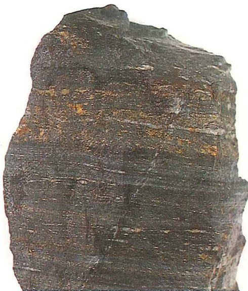
Figur 4. Malmprøve fra Outukumpu. De gule striber er lag med sulfidminerale kobberkis og svovlkis.
