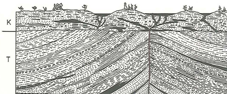
Figur 4. Skematisk snit gennem jordlagene ved Rancho la Brea. I de foldede og forkastede sand- og gruslag fra Tertiærtid (T) er mere porøse lag mættet med olie. I Kvartærlagene (K) på godt 50 m er de tidligere oliepøle ved afgasning og tab af mere flygtige kulbrinter blevet til hård asfalt. Flydende asfalt ses som pøle og søer i den nuværende landoverflade. Modificeret efter Arnold.
