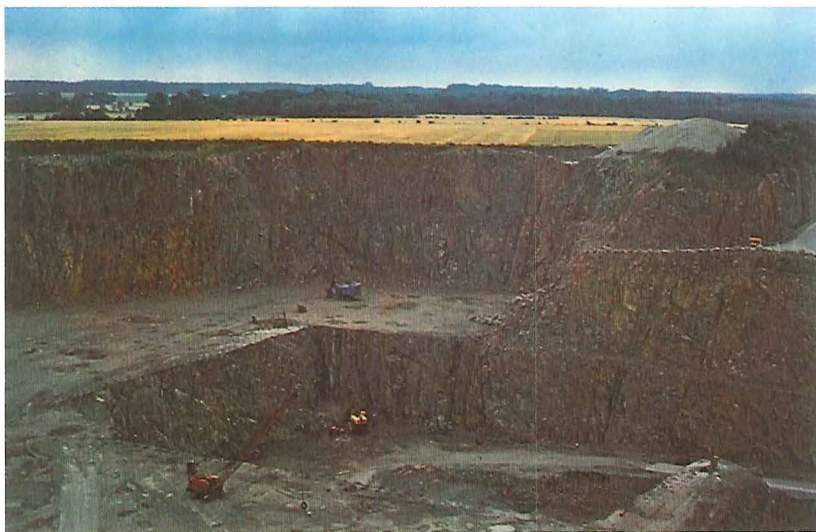
Fig. 6. Rønne Granitværks 80 m dybe brud. Brydningen pågår i øjeblikket i 3. galleri. Yderst til højre ses resterne af 2. galleri, der nu er færdigbrudt.
