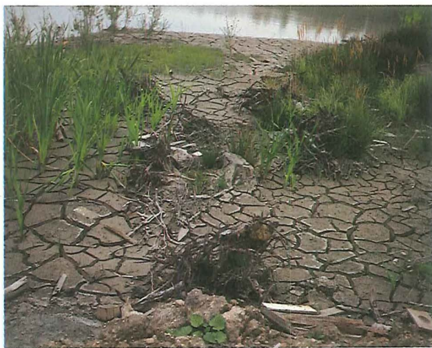
Figur 2. Når ler tørrer, skrumper det. I naturen kan det give ophav til sprækkedannelser, som helst skal undgås i formede teglprodukter. Foto: S.Sjørring.
