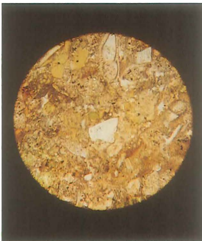
Figur 57. Grønsandskalk fra Lellinge set under mikroskop. Billedet viser skalrester, et skarpkantet kvartskorn og et grønt glaukonitkorn indlejret i en brun grundmasse af ler og kalk.
