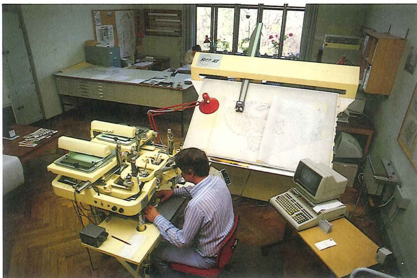
Figur 7. Udtegning af geologiske kort fra luftbilleder i GGU's flyfotolaboratorium. Foto: M. Sønderholm.
