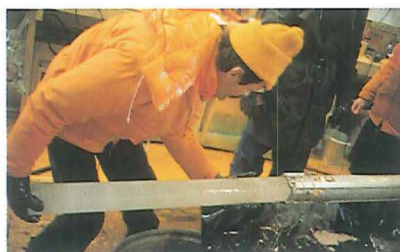
2 meter iskerne tages ud af det dansk konstruerede bor ISTUK.
