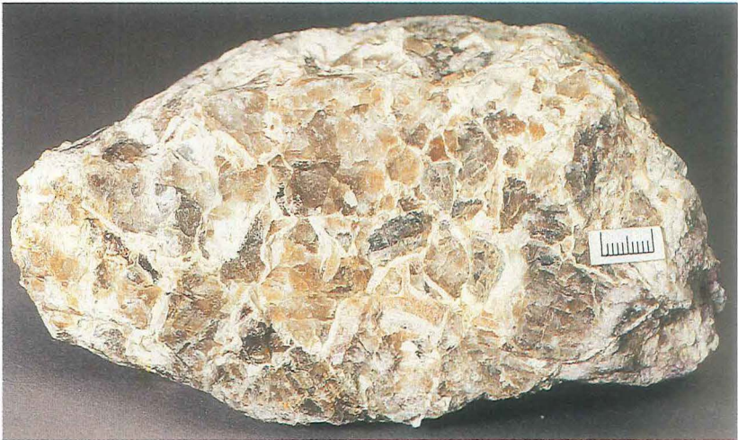
Figur 5. Fluorit-kryolit. En breccie af lysegrå kryolit cementeret af topas.
