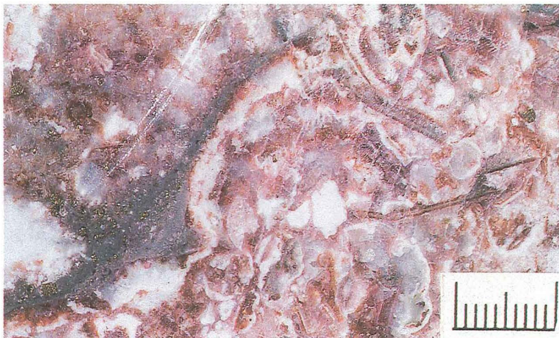
Figur 6. Fluorit-topas med kolloidalt udfældet fluorit (violet). Denne er breccieret gentagne gange og cementseret af topas.
