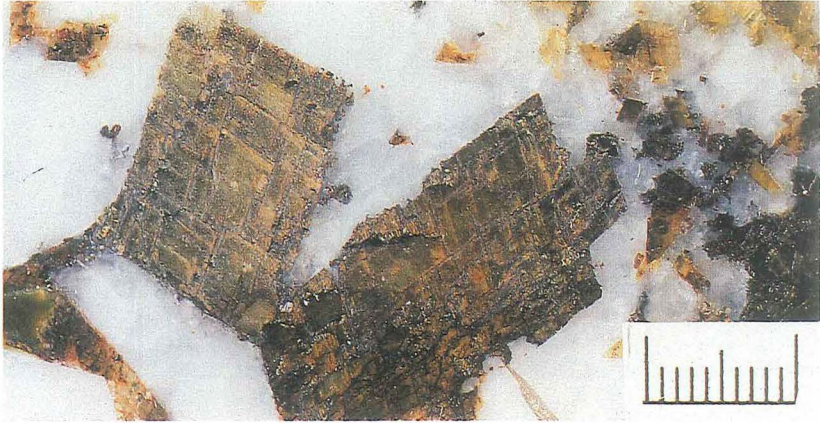
Figur 7. Siderit-kvarts med spaltestykker af siderit (brunt).
