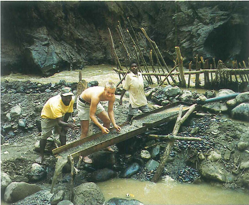
Figur 3. Placerforekomster udnyttes i mange lande af lokalbefolkningen som en ekstra indtægtskilde. Ved hjælp af simple redskaber kan store mængder af sediment hver dag sorteres og finkæmmes for guld. I sjældne tilfælde dukker særligt store 'gold nuggets' frem af sandet - til tider på størrelse med hønseæg! Billedet er fra højlandet i Papua Ny Guinea, hvor de centrale flodsystemer er tætbeholdet med 'lokale' guldgravere.
