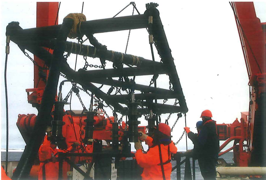
Figur 4. For at indsamle seismiske data slæbes en række luftkanoner efter skibet.
