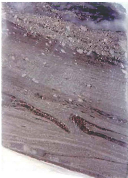
Figur 3. Eksempel på en sulfidforekomst, hvor sulfiderne er bundet til bestemte lag (stratabound eller stratiform).
