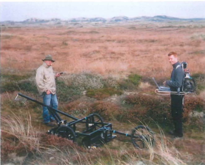
Figur 4. Opsætning af georadarudstyret, så det er klart til brug.
