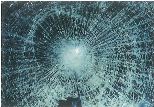
Figur 3. Sprækkedannelser i rude udsat for stenkast. Bemærk de radierende og cirkulære til elliptiske sprækker. Sidstnævnte svarer til omtalte keglegange
