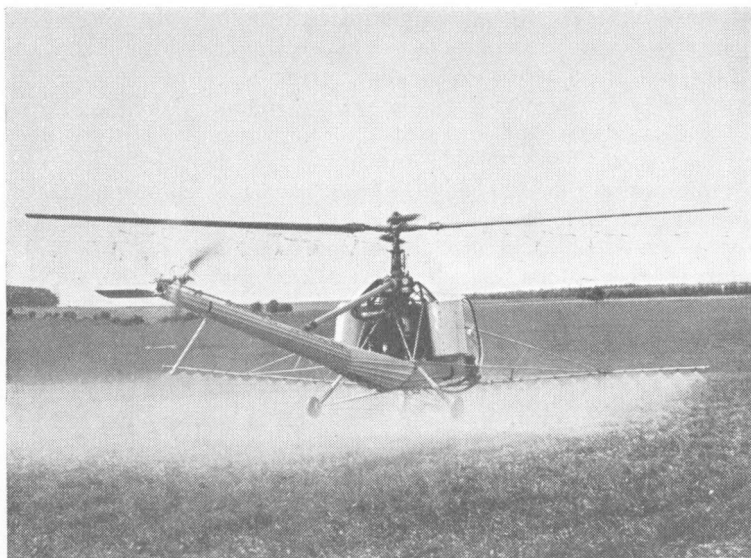
Fig. 1. Ved sen udbringning af flydende kvælstofgødning til hvede har man taget helikopteren i brug. Den kan under gunstige flyveforhold sprøjte ca. 250 tdr. ld. om dagen. (Helikopteren ses her i virksomhed med sprøjtning mod ukrudt).
