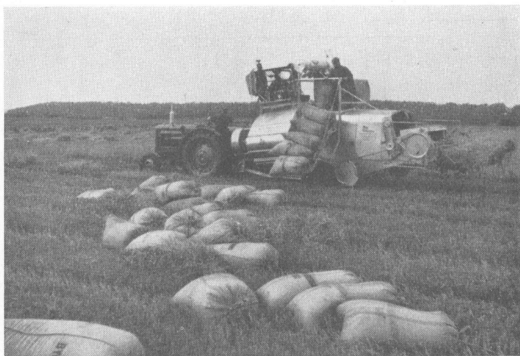
Fig. 1. Et ikke ringe slæb er forbundet med at opsamle de aflagte kornsække, hvorfor der er stigende interesse for at føre sækkene direkte fra mejetærskeren over på vognene til hjemkørsel.
