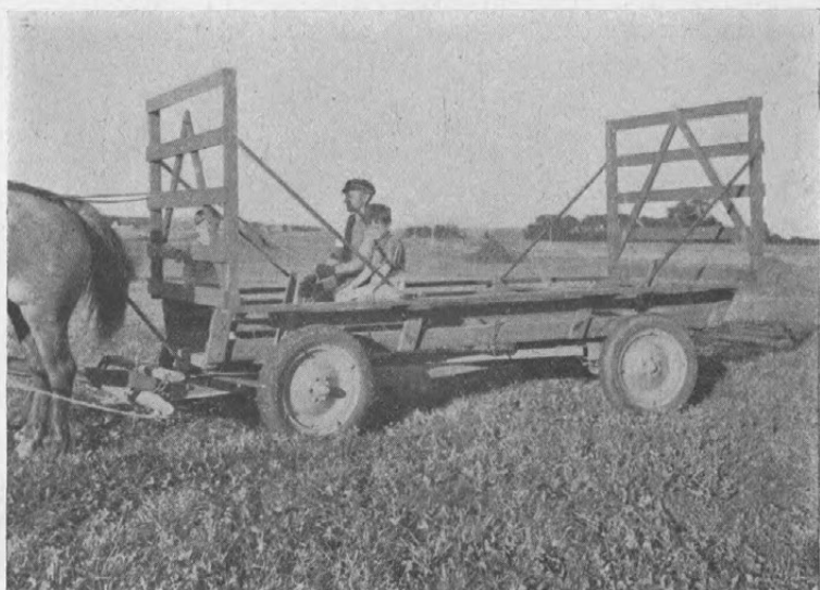
Fig. 9. Lavtbygget Vogn med Gummiringe, forsynet med specielt Høstlad med Endevægge.
