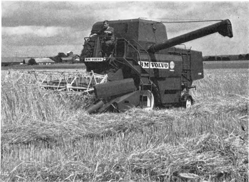
BM Volvo S950 med 16 fods skårbredde i arbejde. Den 98 hk motor ved normalt omdrejningstal skulle selv i svære og højtstående afgrøder klare problemerne.
