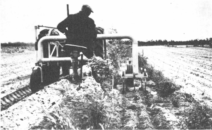
Fig. 7. Kultivator specielt konstrueret til renholdelse mellem hegnsrækker.
