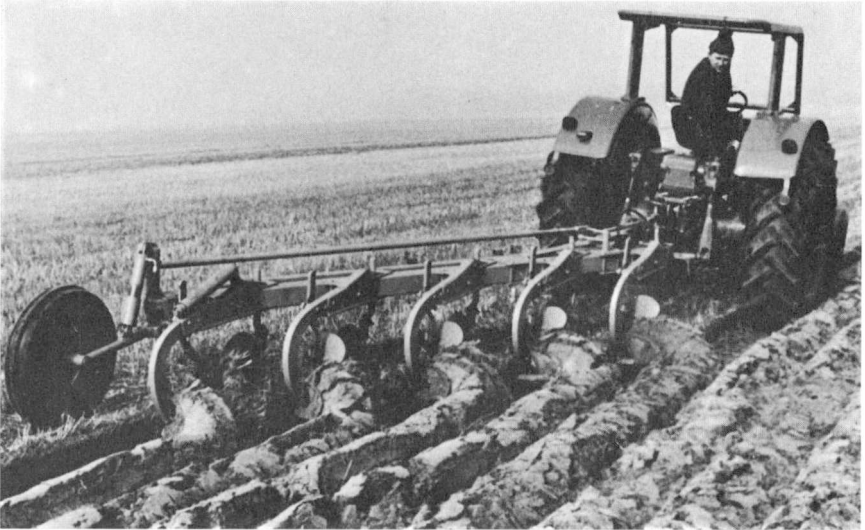
Fig. 2. Moderne plove er højt udviklede, men på store modeller er stensikring blevet en nødvendighed. Som demonstration er bageste plovlegeme her forsynet med selvstændig, hydraulisk stenudløser.
