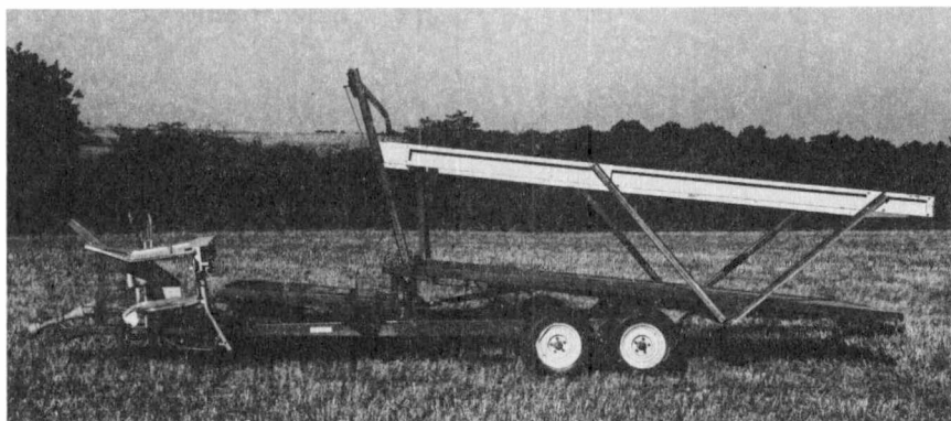
Automatisk ballevogn. Opsamler og stabler ballerne på vognen, og læsser dem af enkeltvis i transportør.
