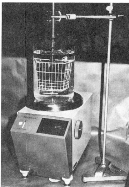
Hårdheden kan vurderes ud fra massefylden, der beregnes efter måling af de sammenpressede enheders rumfang og vægt.
