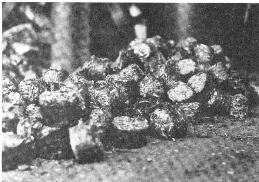
En massefylde på omkring 1,0 synes at være passende med hensyn til hårdhed contra sammenhængsevne og rumvægt.
