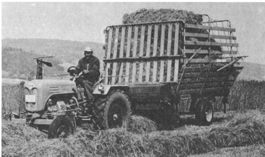
Selvlæssende vogn med pick-up. Der køres over det skår, der skal opsamles.
