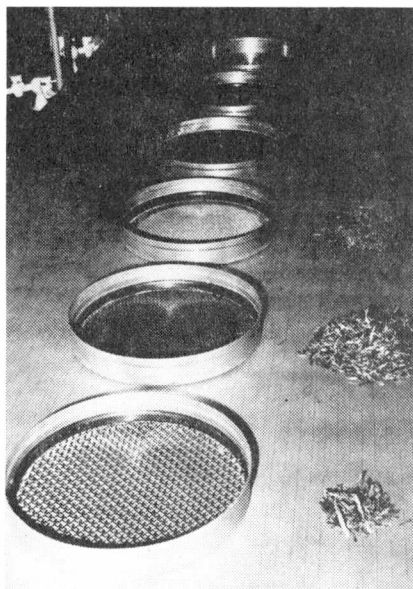
Partikelstørrelsen bestemmes ved sigtning af materialet efter oplødning, udvaskning og tørring.
