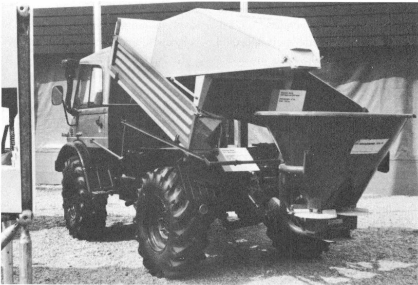
Fig. 6. Unimog med specielt gødningslad og centrifugalspreder.
