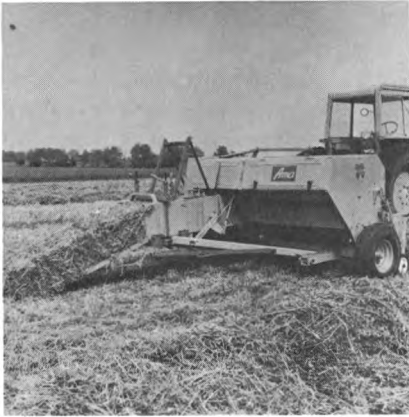
Fig. 28. Hårdpresse. Læg mærke til at slidsken følger ballerne helt ned til jorden. Herved placeres ballerne nøjagtigt, hvilket letter opsamlingen med ballegaffel eller traktormonteret ballekanon.
