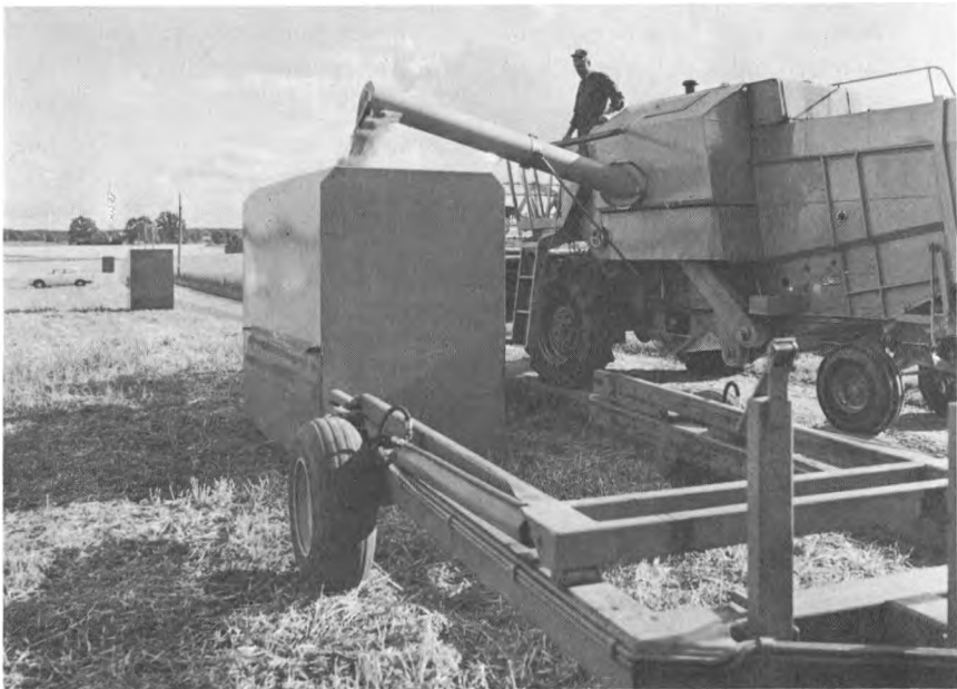
Fig. 26. Overum Containersystem. Containerne placeres på marken, hvor de fungerer som marksilo. Når det passer ind i arbejdsgangen, kan containerne transporteres hjem og tømmes. Hver container rummer 6 eller 8 m 3 .
