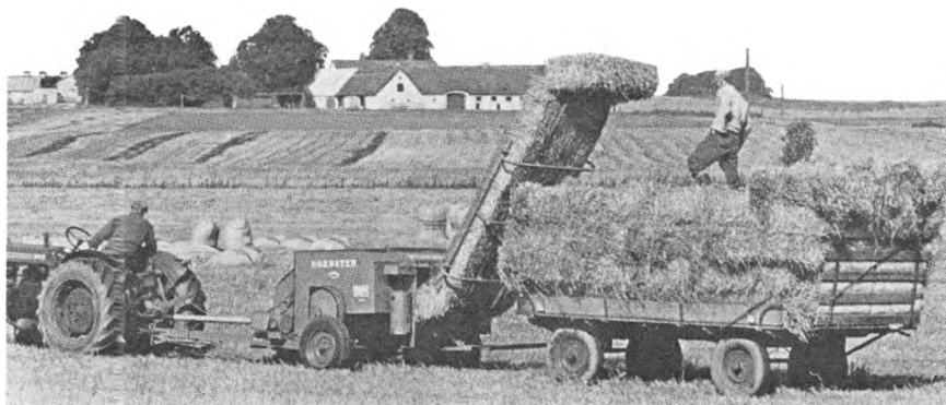
Fig. 31. Letpresse med slidske. En mand på vognen.
