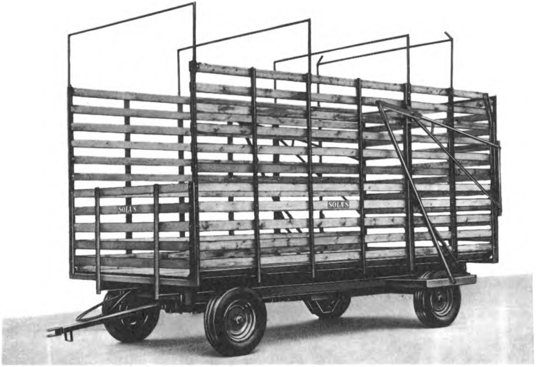
Fig. 40. Stor tipvogn med automatisk oplukkelig bagsmæk.
