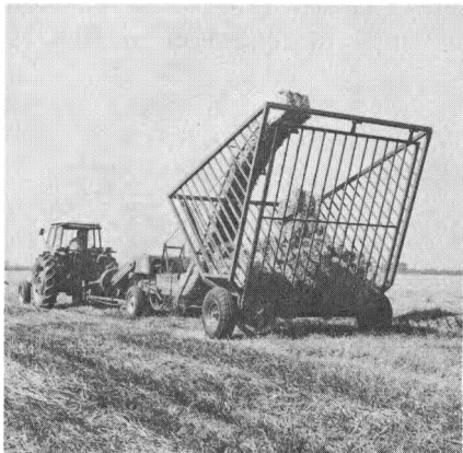
Fig. 39. Stor V-formet ballevogn, der læsses via slidske.
