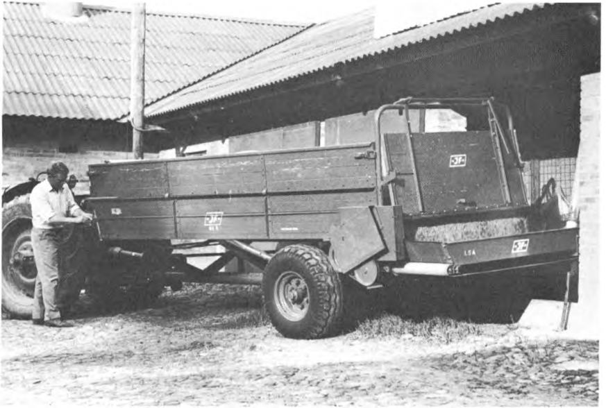
Fig. 19. Universalsvogn med kornudstyr. Aflæsning til siden.
