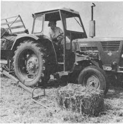
Fig. 34. Ballegaffel, monteret på traktor.
