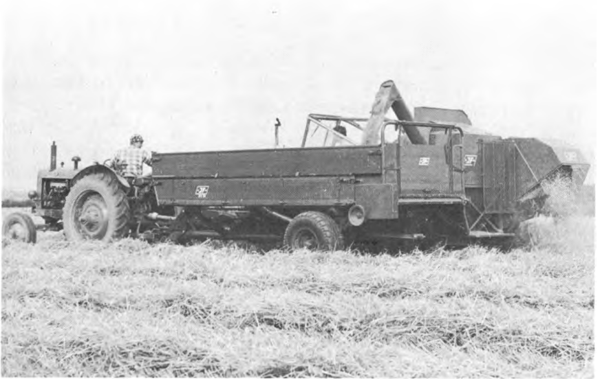
Fig. 20. Tømning af korntank samtidig med at der høstes.
