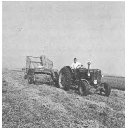
Fig. 30. V-formet ballevogn, der kan rumme 25-35 hårdpressede baller.
