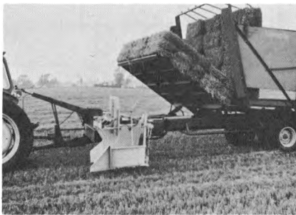
Fig. 35. Automatisk ballevogn. Ballerne er på vej op på ladet fra »andet bord«.
