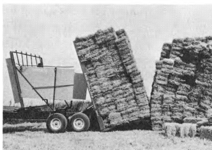
Fig. 36. Staksætning med automatisk ballevogn.
