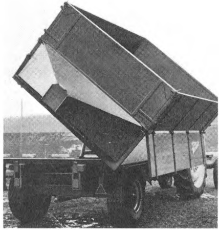
Fig. 21. Tipvogn af fladvognstypen, udstyret med extra høje sider og lav sidetip.
