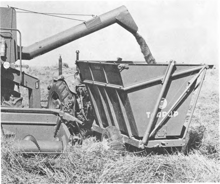
Fig. 22. Tipvogn med høj sidetip.
