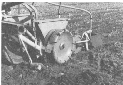
Fig. 4. Unicorn præcisionssåmaskine. Bemærk stenrydderen forrest og den efterfølgende gummibeklædte trykrulle.
