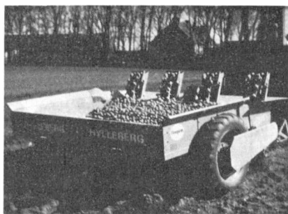
Fig. 7. Ekengård kartoffellægger med tippelad.
