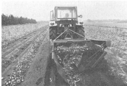
Fig. 19. Frilægning med forrådsoptager.
