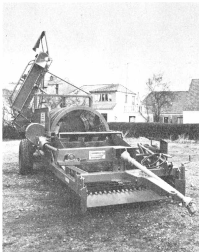
Fig. 1. Stensamlere Stenhater (S.P. Sørensen & Son, Thyregod).
