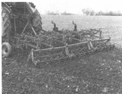
Fig. 3. Forårsharve med let indstillelig og fjederbelastet planerplanke, tvillingspidser og roterende efterharve.
