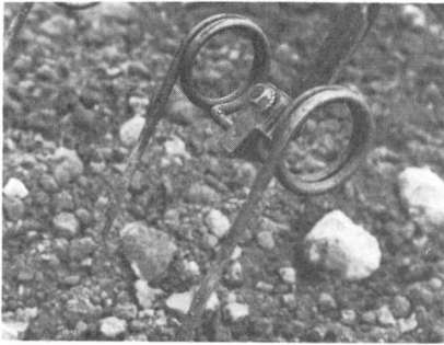
Fig. 4. Meget intensivt arbejdende tvilling-spids i rundstål til harvning i moderat dybde. Der bør da altid anvendes sporløsner-tænder i noget større dybde.
