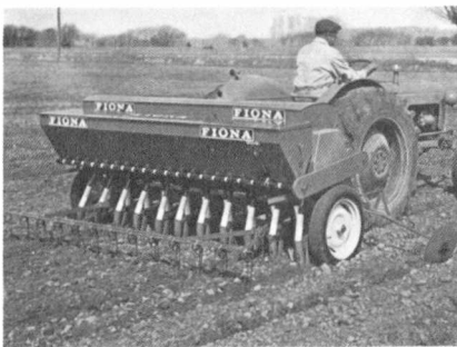
Fig. 5. Radsåmaskine med ekstra såkasse til kunstgødning (Fiona).
