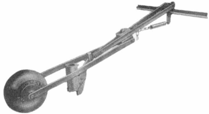
Fig. 6. Trykrulle der anvendes ved roesåning. Anvendes på middelsvære og lettere jorde (Nordsten).
