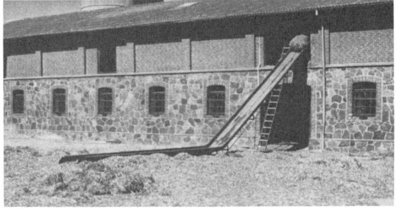
Fig. 48. Halmbane hvoraf 6 m ligger på jorden. Dette giver en god arbejdsplads (Befa).
