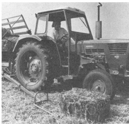
Fig. 42. Læsning med ballegaffel (-JF-).
