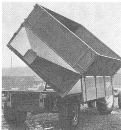
Fig. 23. Tipvogn af fladvognstypen, udstyret med ekstra høje sider og lav sidetip ( Rational Variant ).
