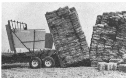
Fig. 40. Staksætning med automatisk ballevogn. Ballevognen kan også læsse halmballerne af enkeltvis i transportør.
