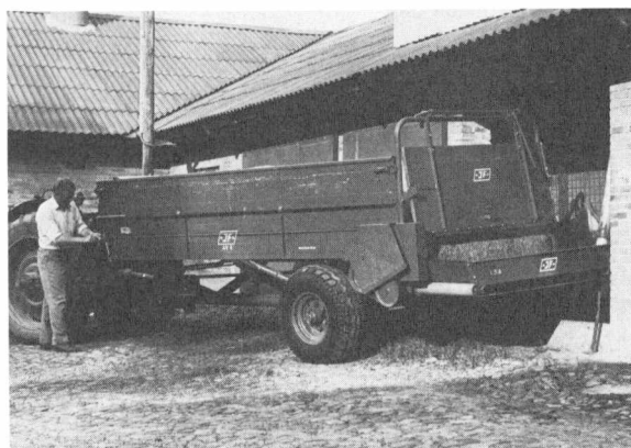
Fig. 22. Universalvogn med kornudstyr. Aflæsning til siden (-JF-).
