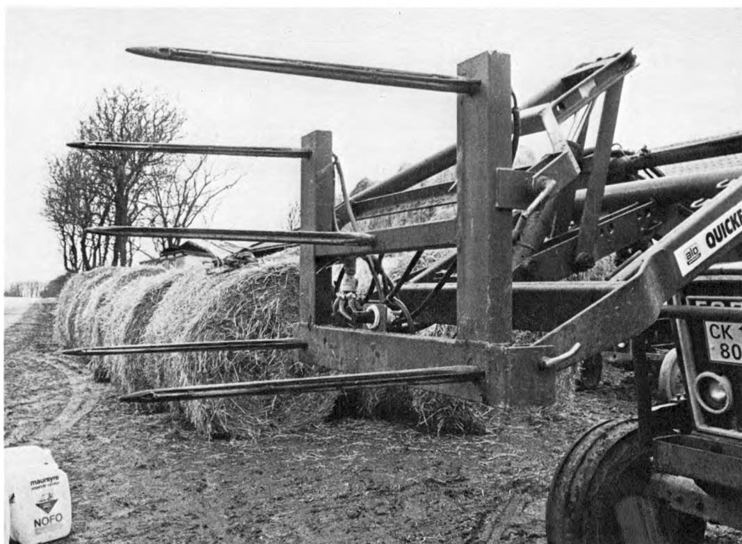
Fig. 19. Med 5 tilsætningsgrene bliver ammoniakken mere jævnt fordelt. Det har især betydning i rundballer af ikke helt tørre stråafgrøder.
