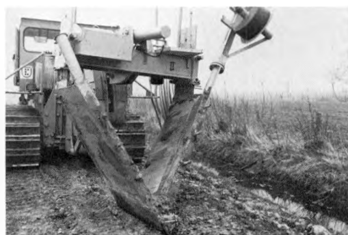
Fig. 24. V-formet jordsværd på en gravefri drænmaskine. Er specielt egnet til stenfri jord. Drænelledningen fører ned gennem sværdets højre side, hvor der fra rullen lægges et filter omkring rørene.
