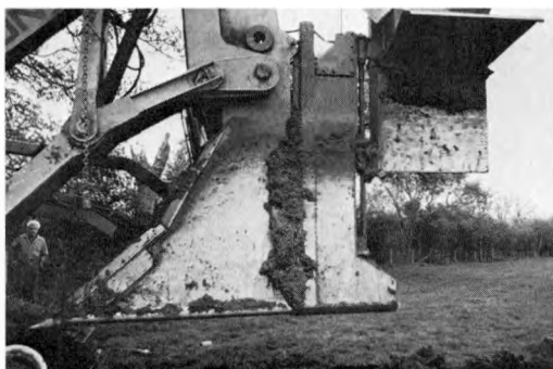
Fig. 23. L-formet jordsværd på en gravefri drænmaskine. Eget til de fleste jordtyper. Kassen bagest på jordsværdet er til efterfyldning af renden med grus o.l.
